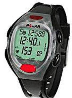
контроля и прогнозирования перетренировки по скорости релаксации и RR-интервалам сердечных сокращений. Объем памяти: В режиме записи каждого удара R-R запись: около 30 000 ударов сердца. В режиме записи с временными интервалами 5 секунд: 44 часа 13 минут. 15 секунд: около 120 часов. 60 секунд: около 500 часов.
